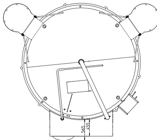
Для установки требуется 9 монтажных отверстий 25 мм для анкеров (9 x 40°)
